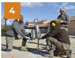
**Ensayos penetrométricos** pre y post intervención.
